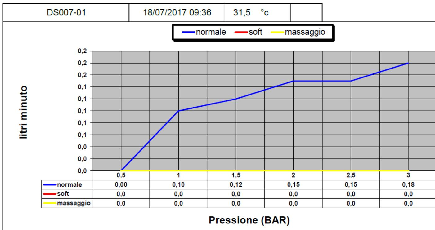
I valori di portata sono rilevati con pressione dinamica costante all'ingresso dell'erogatore
