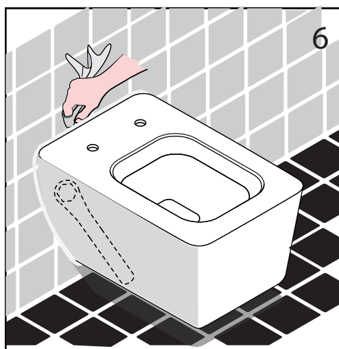
FIG6 TIRARE FINO A FAR ADERIRE IL SANITARIO A PARETE SENZA FORZARE, ED ELIMINARE LA MALTA O IL CEMENTO IN ECCESSO. DOPO, CHE IL COMPOSTO E' INDURITO, FINIRE DI AVVITARE SENZA ESAGERARE EVITANDO COSI' DI DANNEGGIARE LA CERAMICA. ENSURE ALL SCREWS ARE TIGHTENED SECURELY BUT DO NOT FORCE THEM.AFTER THE MORTAR OR WHITE CEMENT HAS SET, FINISH SCREWING THE CERAMIC PRODUCT IN PLACE
