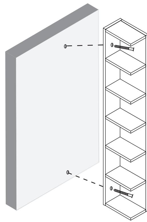
Forare il muro ed avvitare i tasselli in dotazione considerando la posizione dei fori sulla schiena del mobile.
