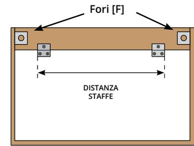
Appoggiare il mobile sulle staffe metalliche e segnare sul muro i due fori F delle piastre angolari (già fissate all'interno del mobile). Togliere il mobile, effettuare i fori sul muro con una punta 8mm x 70mm
