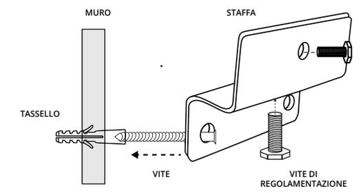
Posizionare a muro delle staffe di supporto per la base utilizzando come riferimento l'immagine. Fissare a muro le 2 staffe di supporto del mobile. Prima del fissaggio definitivo dei mobili, agire sulle viti di regolazione per livellare la base.
