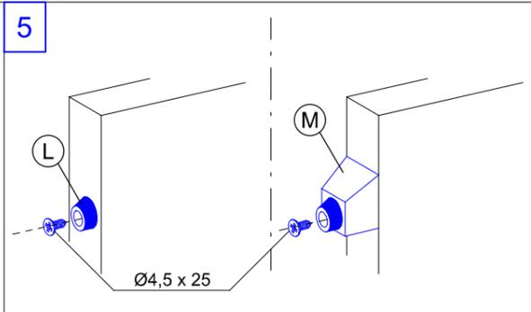
Fissare i gommini di battuta (L) sul fianco posteriore della porta. Per la scomparsa parziale inserire uno spessore (M).
