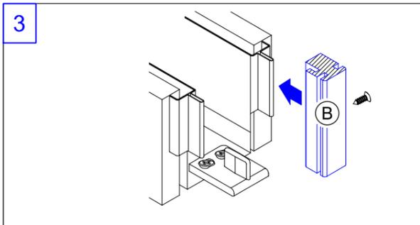
Incastrare un montante (B) nell'apposita lamella. Forare montante e lamiera e fissare con viti autofilettanti o fissare con silicone.
