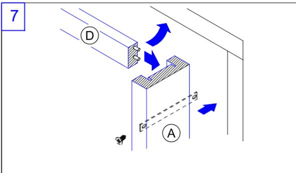
Inserire il traverso (D) sul montante (B) precedentemente fissato, incastrare il montante di battuta (A) e fissarlo in posizione.
