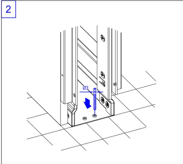
Se necessario ripassare con una punta ø3mm i fori di fissaggio per la guida a pavimento.
