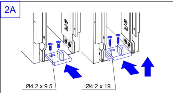
Fissare la guida a pavimento utilizzando le viti 4,2x9,5. Se il cassonetto è stato montato sotto il livello del pavimento utilizzare gli spessori in dotazione e le viti 4,2x19.
