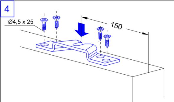
Fissare le staffe di sospensione con l'asse dell'asola a 150 mm dal bordo della porta. Nota: l'apertura dell'asola delle staffe deve essere rivolta verso il lato del montante "B" montato in precedenza.
