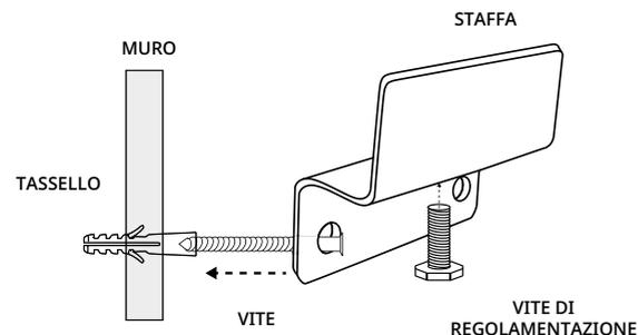
Fissare a muro le 2 staffe di supporto del mobile.
