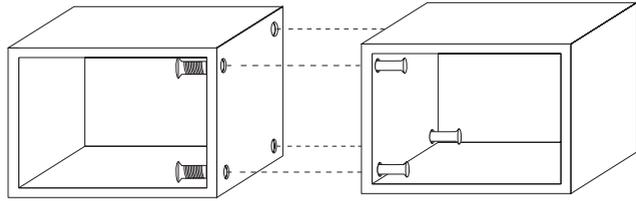
Per il montaggio, affiancare i moduli in modo da far combaciare i fori laterali e successivamente inserire e avvitare le viti di unione.
