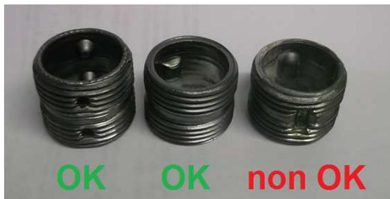
Attenzione: non utilizzare prodotti per la tenuta idraulica quali canapa, mastice o simili perché compromettono la tenuta del sistema di Elite costituito dai nipples + o-ring originali. Elite declina ogni responsabilità per perdite o altri inconvenienti causati dall'uso di questi materiali ed il loro impegno fa decadere la garanzia sul prodotto.
