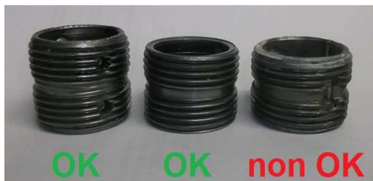
A lato si rappresentano due nipples originali, che hanno la sede dell'o-ring (scanalatura centrale) ininterrotta su tutta la circonferenza ed un terzo nipples non conforme, con la sede dell'o-ring non adatta all'uso.
