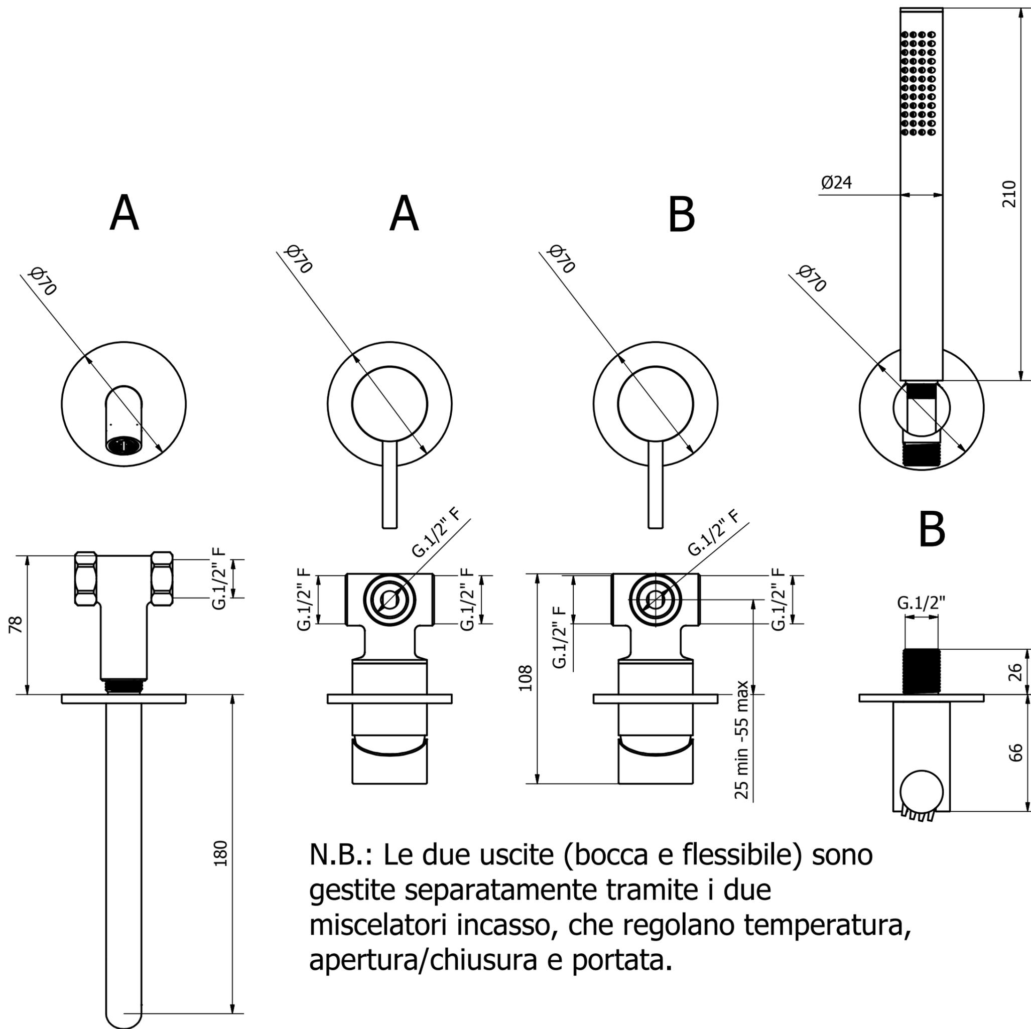
N.B.: Le due uscite (bocca e flessibile) sono gestite separatamente tramite i due miscelatori incasso, che regolano temperatura, apertura/chiusura e portata.
