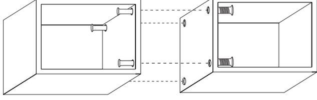
Per il montaggio, affiancare i moduli in modo da far combaciare i fori laterali e successivamente inserirle e avvitare le viti di unione.
