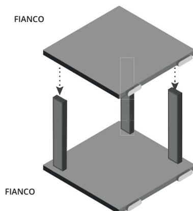
Ruotare la struttura in verticale sorreggendo entrambi i fianchi.
