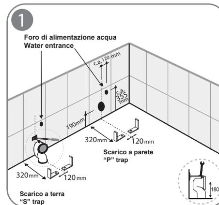
1 - Predisporre l'alimentazione acqua, gli scarichi e posizionare le viti di fissaggio mantenendo la distanza come mostrato nella figura 1.
