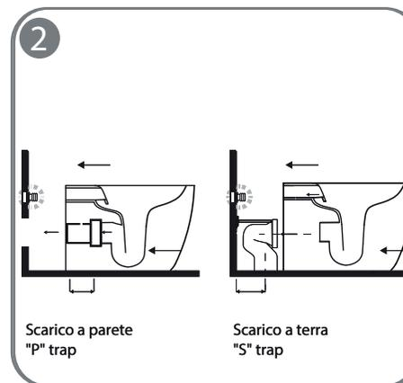
2 - Predisporre le connessioni di scarico della cassetta, montare le connessioni dello scarico e tagliare a misura, sistemare il vaso e spingerlo verso la parete assicurandosi che tutte le connessioni combacino perfettamente. Per facilitare la connessione si suggerisce di lubrificare entrambe le parti.
