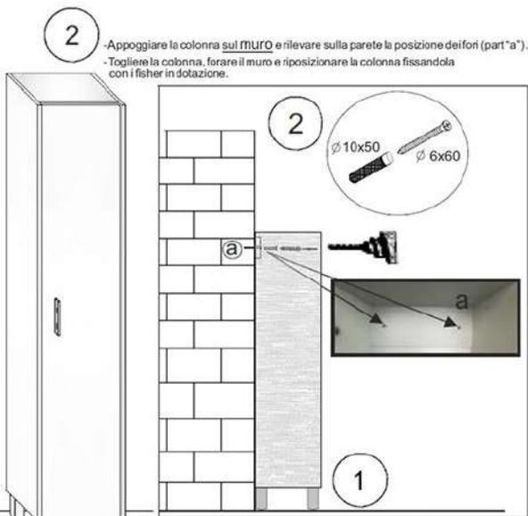
2 - Appoggiare la colonna sul MURO e rilevare sulla parete la posizione dei fori (part "a").
