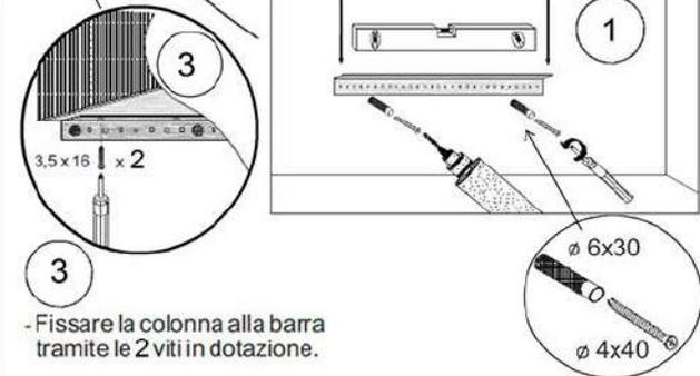
3 - Fissare la colonna alla barra tramite le 2 viti in dotazione.
